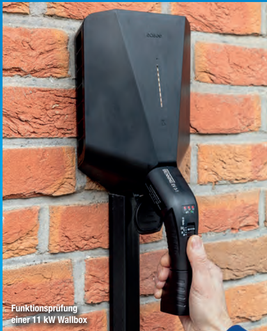
VDE-Sicherheitsprüfung mit Installationstester BENNING IT 200
