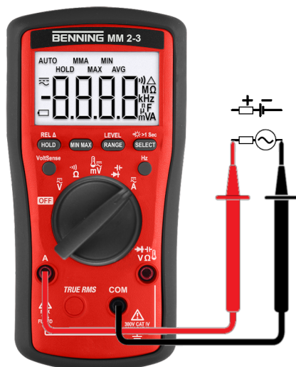
Obrázek 10: Měření proudu nebo frekvence
