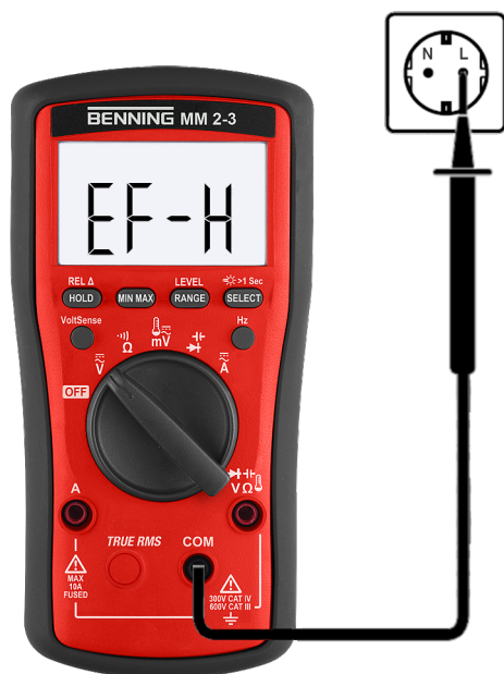
Obrázek 15: Provádění zkoušky vnějšího vodiče nebo fází
