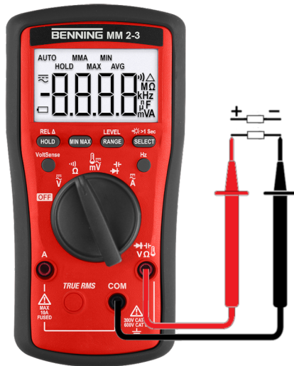
Obrázek 11: Měření odporu nebo zkouška průchodnosti
