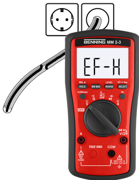
Obrázek 14: Bezdotyková zkouška fází
