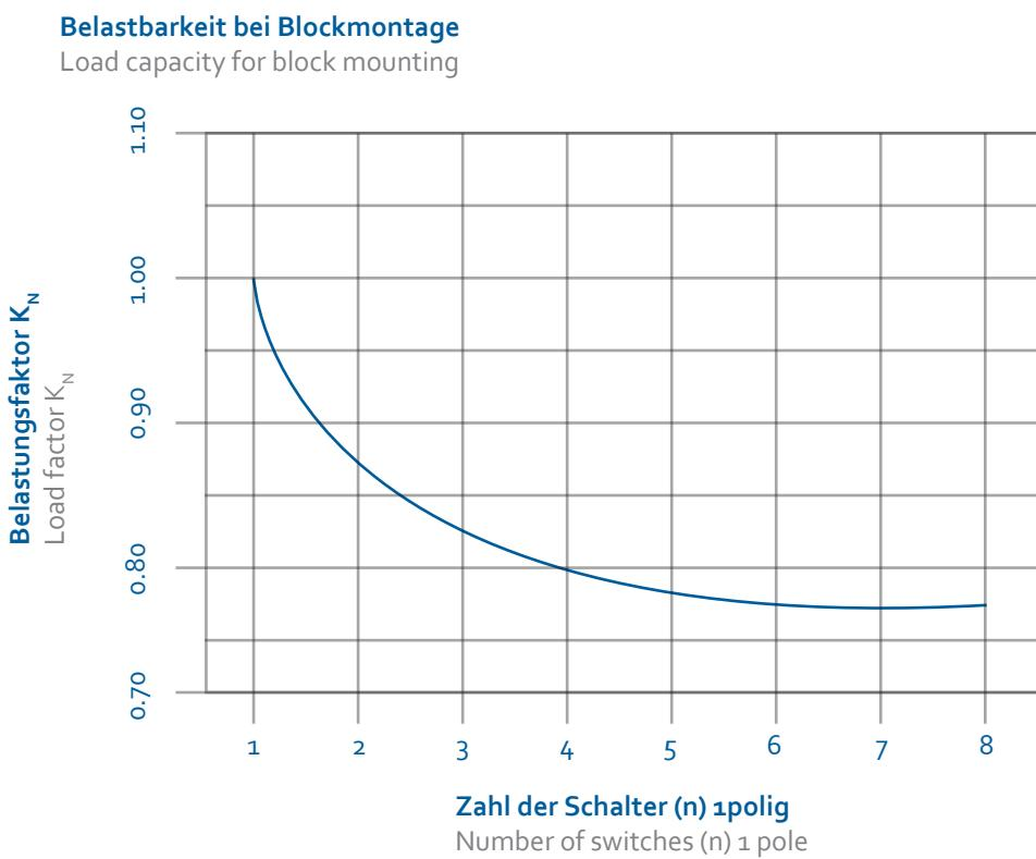
Zulässige Dauerbelastung bei Umgebungstemperatur T (°C) und n Schaltern:  $IL = \ln K_T(T) K_N(N)$ .
