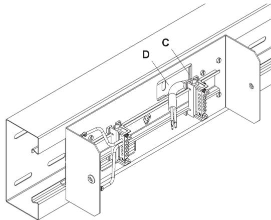
4. Oberteil aufsetzen und verschrauben.
