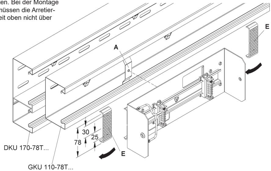
2. Das Unterteil der Automateinheit auf den Kanal aufrasten und mit der Haltefeder (A) verschrauben (Schraube B).
