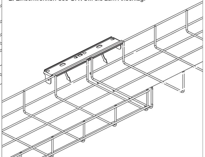
3.-5. Die seitlichen Laschen des GRVS... mit einem Schraubendreher um den senkrechten Querdraht der Gitterrinnen eindrehen.
