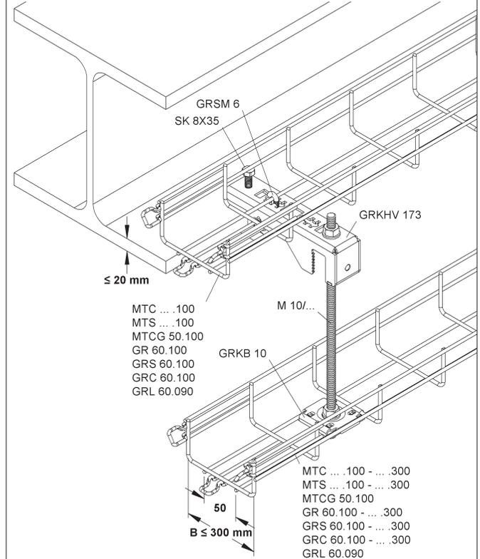
Durch Auslässe in der horizontalen Auflagefläche besteht die Möglichkeit zur Montage von bis zu 4 Bügelschellen B(K) 12 - 90 (je nach Größe) in Registerverlegung. Rechtwinklige Aussparungen in den Schenkeln der Klemme ermöglichen zudem eine Montage von Kabelschutzrohren  $\varnothing$  30 mm.
