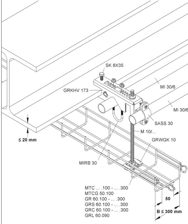
Eine wechselseitige Anordnung der Hakenschrauben gewährleistet eine sichere Befestigung der Gitterrinne an der Gitterrinnen-Befestigungsklemme. Auch hier kann eine Abhängung an der Befestigungsklemmenspitze mittels Gewindestab M 10/... erfolgen.
