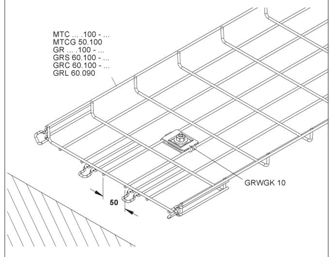
**3. Zur zentralen variablen Gewindestangenabhängung von Gitterrinnen mit einem mittigen Bodenlängsdrahtabstand von max. 50 mm und mind. zwei Bodenlängsdrähten.**
