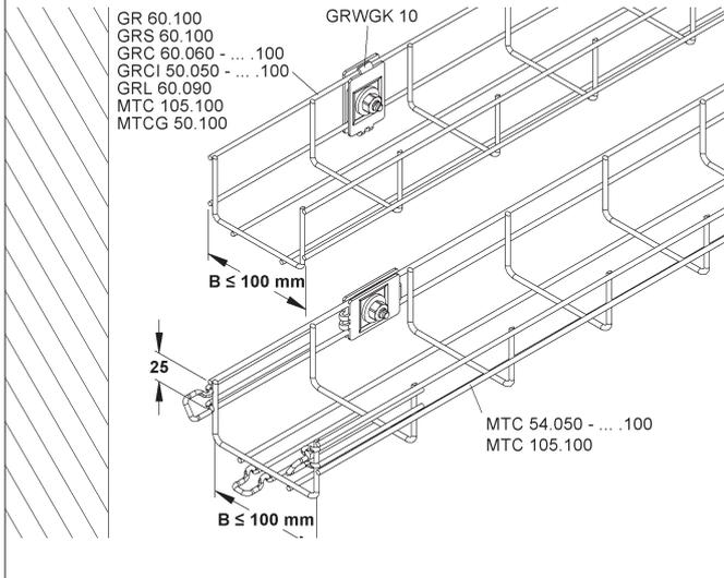
**2. Zur Bodenbefestigung von Gitterrinnen mit einem mittigen Bodenlängsdrahtabstand von max. 50 mm und mind. zwei Längsdrähten.**
