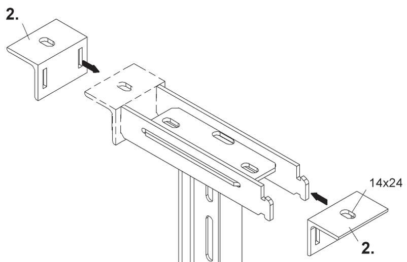
3. Vergrößerung des Befestigungsabstandes der Dübel zur Erhöhung der Tragfähigkeiten der HI 80/... Hängestiele.
