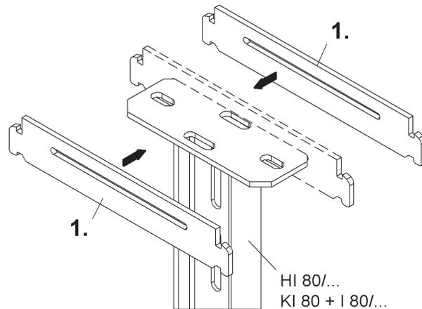
2. Die Winkel des Kopfplattenadapters KIA 80 auf den Hammerkopf der Seitenteile einhängen.
