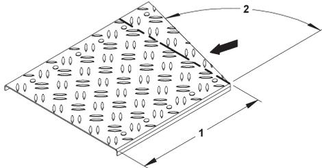
2. Deckel wenden und mit dem Schlagdom die den Schnittkanten am naheliegenden Vorprägungen entfernen (1).
