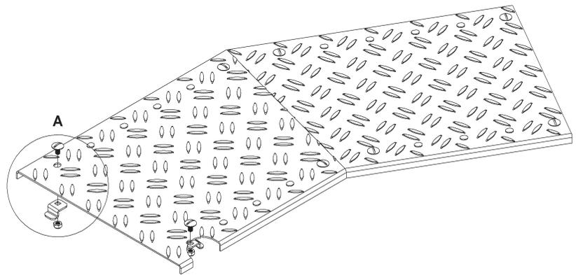
4. Kabelrinnendeckel **RDRS...-2.0** auf die Kabelrinne auflegen, Schraubendreher ansetzen und den Drehriegel entsprechend eindrehen. Die Drehriegelplatte greift unter die gerollte Längskante der Kabelrinne und gewährleistet somit eine klemmende Verbindung zwischen Deckel und Kabelrinne.
