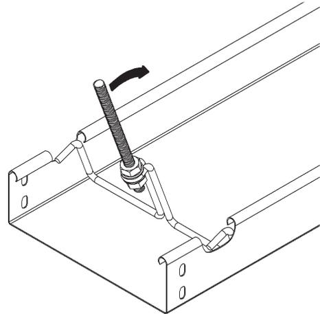
3. Die Position der waagerechten Drähte liegt nun in den eingerollten Kanten der Kabelrinne.
