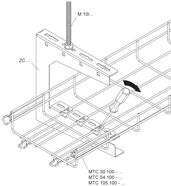
Lochungen in der unteren Auflagefläche der Zentralabhängung **ZC...** ermöglichen verschiedenste Ein- und Anbauten wie beispielsweise die Montage eines Trennsteges **RW...**
