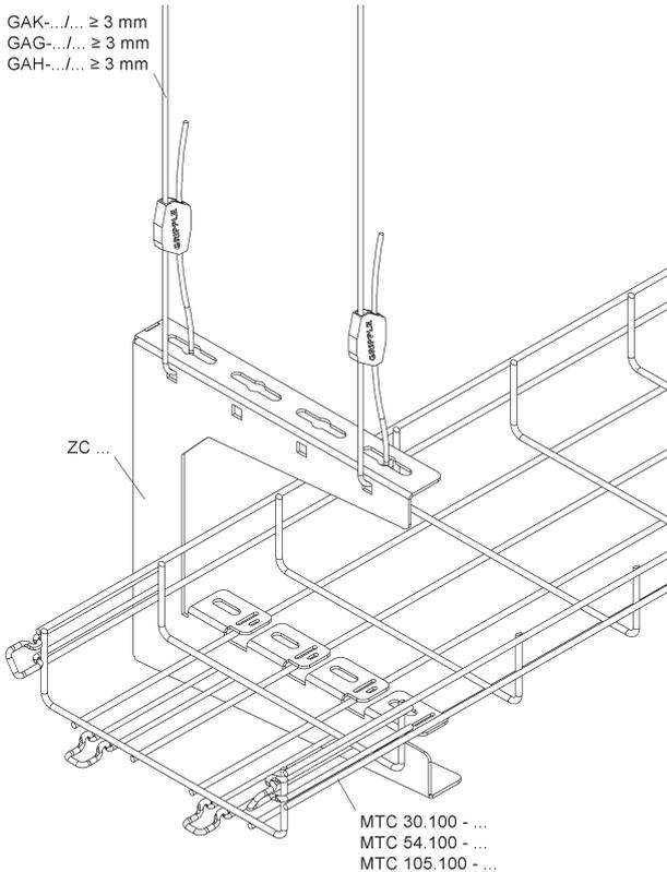
Eine Nutzung, nicht nur als Zentralabhängung **ZC...**, sondern, auch auf Grund einer Lochung im Rückenteile, als doppelter Ausleger zur Wandmontage, unterstreicht die Multifunktionalität dieser Abhängung. Montiert werden können alle Niedax Kabelrinnen sowie Gitterrinnen **MTC...** sowie deren Kombination. Die Belastungsangaben mit der Einleitung der Lasten sowie die ausreichende Verankerung mit dem tragfähigen Untergrund sind zu berücksichtigen.
