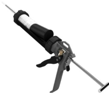
4. Die Kartusche senkrecht nach oben halten und pressen, bis das Mischrohr zu ca. drei Vierteln ausgefüllt ist. Anschließend alle Zwischenräume zwischen den Installationen mit dem Brandschutzschaum in einer Schottstärke von mind. 75 mm vollständig ausfüllen, so dass ein fester und dichter Anschluss an das Bauteil entsteht. An den Installationen ist abschließend beidseitig eine Wulst aus Brandschutzschaum vorzusehen (siehe Kapitel 6).
