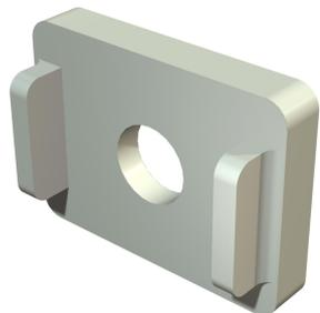
Zur Vergrößerung der Klemmhöhe bei Kabelklammern von 9 auf 13 mm bei dickeren Leitungen, schlagfestes Polystyrol.
