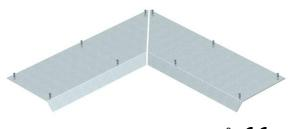
Blinddeckel 2-teilig zum Abdecken des Innenecks eines Aufflurkanals, passend zu den Kanalunterteilen AIK/U inkl. 10 Befestigungsschrauben. Der Kanaldeckel wird in den Al-Seitenprofilen des Kanalunterteils festgeschraubt. Die Deckelschräge überragt das Kanalunterteil im 45°-Winkel.
