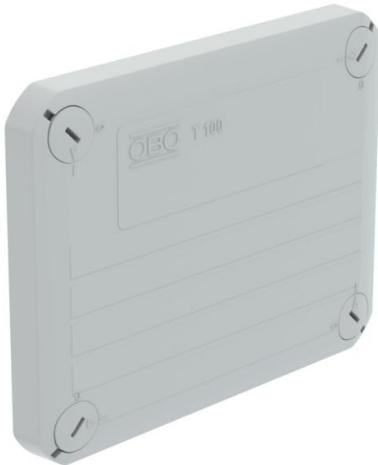
Steckbarer Deckel zum Verschließen von Kabelabzweigkästen, ausgestattet mit Ausbrechöffnungen für mehrpolige Stecksysteme oder DATA-Systeme auf Keystone-Basis. Mit Schnellverschluss im Deckel, plombierbar. Halogenfreies Material, UV-resistent. Flammwidrig nach DIN EN 60695-2-11, Prüftemperatur 650°C. Schlagfestigkeit IK07 bei Raumtemperatur. Schutzart IP30.
