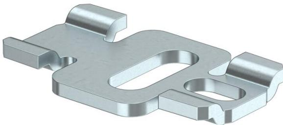
Mit der praktischen Außenbefestigung bzw. -verbindung können die Kabelkästen und Kleinverteiler der S- und SDB Serie problemlos an der Wand befestigt werden. Durch die Befestigung außerhalb des Klemmraums ist eine Spannungsverschleppung ausgeschlossen.
