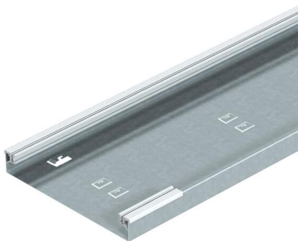
Abzweig-Aufflur-Installationskanal-Unterteil für Blind-/Montagedeckel mit beidseitiger Abschrägung, zur Montage frei auf dem Fußboden, mit aufsteckbaren Aluminium-Seitenprofilen zum Auflagern und Befestigen der Kanaldeckel. Kanalhöhe geeignet zum Aufbau von Teiltanks.
