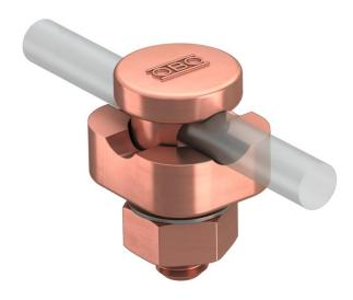
• Mit Fix-Kontakt-Klemmschraube, Mutter und Fächerscheibe • Mit Bohrung 10,2 mm • Mit vormontiertem Druckstück aus Zinkdruckguss • Entspricht den Anforderungen nach VDE 0185-305 (IEC 62305)
