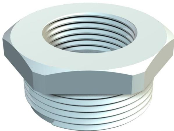
Reduktion mit PG-Innen- und -Außengewinde nach DIN 40430 für die Montage von Kunststoff-Kabelverschraubungen an Gehäusen. Schutzart IP54 ohne zusätzliche Anschlussdichtung. Schutzart bis IP68 möglich mit zusätzlicher Anschlussdichtung, zum Beispiel O-Ring oder Flachdichtring.
