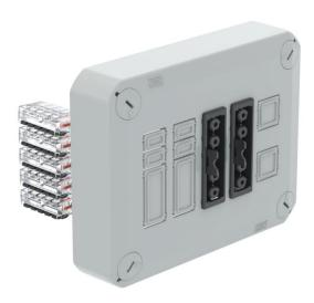
Steckbarer Deckel zum Verschließen von Kabelabzweigkästen, bestückt mit 2 Wieland GST18-Stecksystemen, vorverdrahtet mit Hebelsteckklemmen. Mit Schnellverschluss im Deckel, plombierbar. Halogenfreies Material, UV-resistent. Flammwidrig nach DIN EN 60695-2-11, Prüftemperatur 650°C. Schlagfestigkeit IK07 bei Raumtemperatur. Schutzart IP30.
