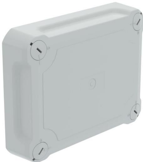
Steckbarer Deckel zum Verschließen von Kabelabzweigkästen, ausgestattet mit Ausbrechöffnungen für mehrpolige Stecksysteme oder DATA-Systeme auf Keystone-Basis. Mit Schnellverschluss im Deckel, plombierbar. Halogenfreies Material, UV-resistent. Flammwidrig nach DIN EN 60695-2-11, Prüftemperatur 650°C. Schlagfestigkeit IK07 bei Raumtemperatur. Schutzart IP30.
