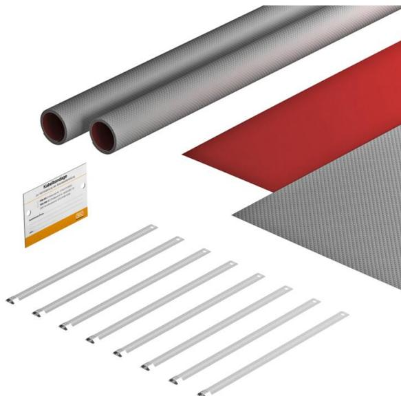
Komplettset zur Umhüllung von Kabelbündeln oder Kabeltrag-Systemen ohne Deckel zur Verhinderung der Brandweiterleitung. Anwendung im Außenbereich. Die Sets enthalten jeweils 4 Abschnitte der witterungsbeständigen Kabelbandage PYROWRAP® Wet, 8 Metallbandschellen und ein Kennzeichnungsschild. Ausreichend für ca. 2 m Länge.
