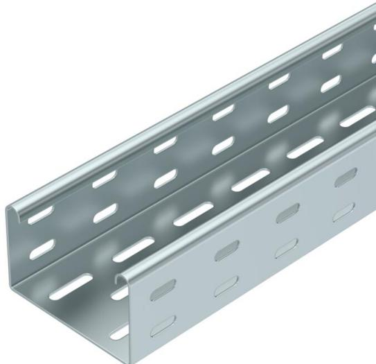
Gelochte Kabelrinne zur Verlegung von Kabeln und Leitungen, speziell geeignet für die Fördertechnik in der Automobilindustrie. Einsetzbar im Innenbereich. Schraubverbindung. Geeignet für direkte und erhöhte Bodenmontage.
