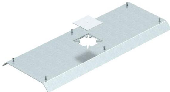
Geräteanschlussdeckel für Abzweigkanalunterteil AIKA/U für den Aufbau eines Teiltanks. Der Kanaldeckel wird in den Al-Seitenprofilen des Kanalunterteils festgeschraubt. Die Deckelschräge überragt das Kanalunterteil beidseitig im 45°-Winkel.
