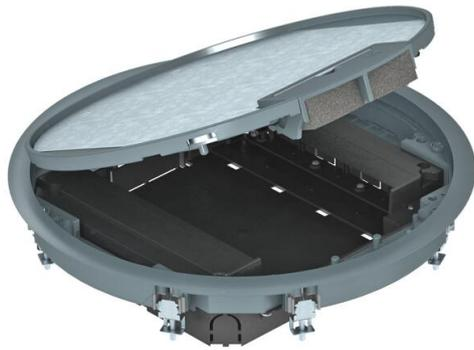
Geräteinsatz GESR9 mit einer festen Bauhöhe von 55 mm im Innenbereich. Mit zwei Einbaueinheiten zur vertikalen Montage von Modul 45-Geräten und vier Zugentlastungen. Zur Montage der Modul 45-Geräte werden zwei Einbaurahmen benötigt.
