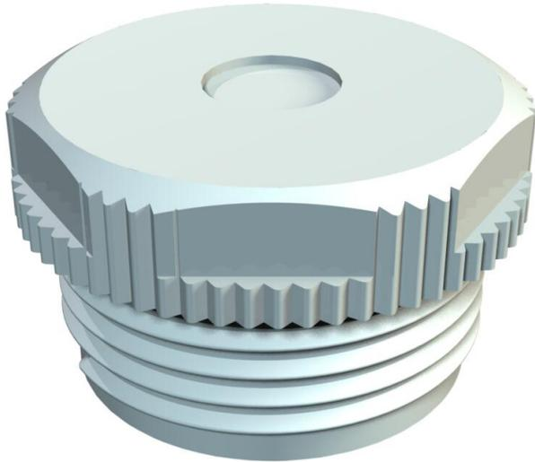
Mit Durchstoßmembrane, hierbei ist die Öffnung D vorgeprägt, aber zunächst verschlossen. Würgedichtung zum Einschrauben in PG-Gewinde nach DIN 40430. Mit selbstdichtendem Konus am Gewindeende, daher kein Anschlussgewindedichtung erforderlich. Erreichbare Schutzart bei sorgfältiger Montage IP54. Mit Durchstoßmembrane, hierbei ist die Öffnung D vorgeprägt, aber zunächst verschlossen.
