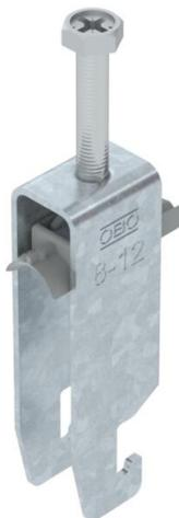
Bügelschelle mit U-Fuß, Kunststoffdruckwanne aus Polypropylen. Zur vertikalen und horizontalen Montage von 3 Einzelkabeln an C-Profilschiene. Für Schlitzweite 18 mm oder 22 mm. Mit 1-gängiger Schraube an Druckwanne, universeller Sechskant-Schraubenkopf SW10, mit Schlitz und Kreuzschlitz. Geeignet für Montage im Innen- und Außenbereich. Mehrere Kabel sollten durch Doppelwannen getrennt werden. Der Einsatz einer Gegenwanne wird empfohlen.
