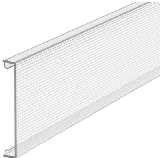
Kanaloberteil zum Verschließen der Geräteeinbaukanäle Rapid 80 GK (PVC), GS (Stahl), GA (Aluminium) und ISS Installationssäulen mit 76,5 mm Systemöffnung. Das Oberteil GK-OTKKP ist aus einem klaren, durchsichtigen PC-Material hergestellt und an der Innenseite kanelliert (Längsriefen) und eignet sich somit zur Integration von Beleuchtung in den Kanälen bzw. Säulen.
