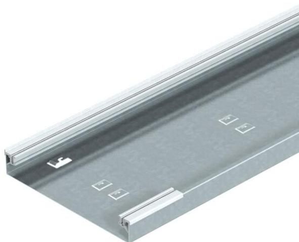
Aufflur-Installationskanal-Unterteil, 1zünftig, für Blind-/Montagedeckel mit einseitiger Abschrägung, mit aufsteckbaren Aluminium-Seitenprofilen zum Auflagern und Befestigen der Kanaldeckel, Bodenwanne mit Haltetaschen für max. 2 einsteckbare, selbstkontaktierende Trennstege und Prägung für Schutzleiteranschlusswinkel. Kanalhöhe geeignet zum Einbau von Geräteeinsätzen der Nenngröße 2.
