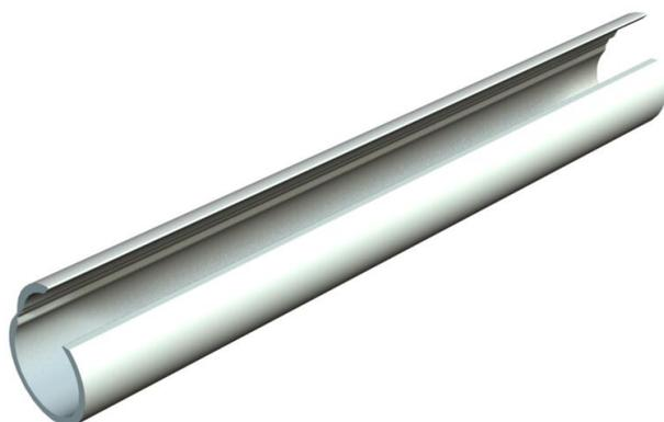
Offenes Rohr Quick-Pipe® aus Kunststoff zum Aufputz-Verlegen von Kabeln und Leitungen im Innen- und geschützten Außenbereich. Montage an Wand und Decke mit Quick-Schelle, proQuick-Schelle und Multi-Quick-Schelle. Werkzeugloses Verschließen und Öffnen durch Drehen in der Schelle. Einsetzbar im Temperaturbereich von - 25° bis + 60° C.
