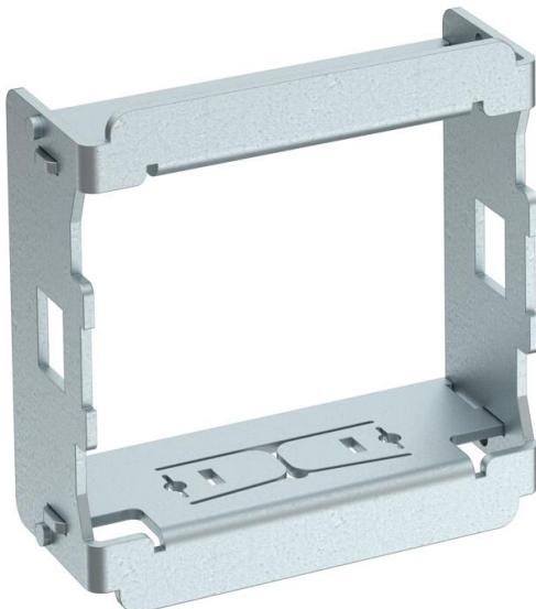
Der Adapter ermöglicht einen um 90° gedrehten Schaltereinbau in z.B. Installationsäulen mit 45er-Spur oder Rapid 45. Passend für alle Schalter und Taster in 1 Modulbreite (45 x 45 mm).
