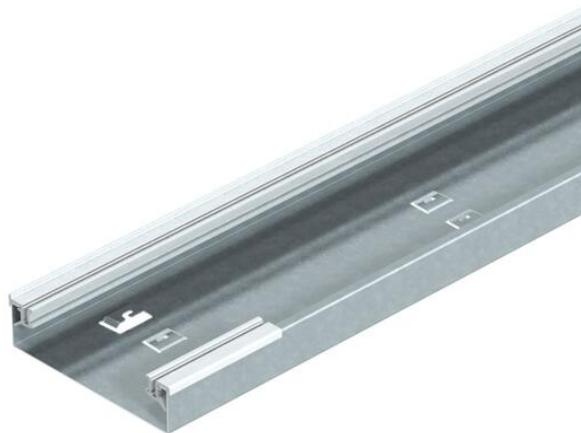
Aufflur-Installationskanal-Unterteil, 1-zügig, für Blind-/Montagedeckel mit einseitiger Abschrägung, mit aufsteckbaren Aluminium-Seitenprofilen zum Auflagern und Befestigen der Kanaldeckel, Bodenwanne mit Haltetaschen für max. 2 einsteckbare, selbstkontaktierende Trennstege und Prägung für Schutzleiteranschlusswinkel. Kanalhöhe geeignet zum Aufbau von Teiltanks.
