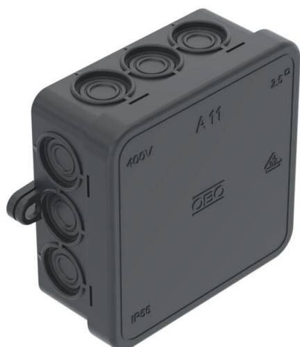
Schutzart IP55, Nennspannung 690 V, Nennquerschnitt 2,5 mm<sup>2</sup>, 12 Einführungen für Kabeldurchmesser 5-14 mm. Klemmdeckel.
