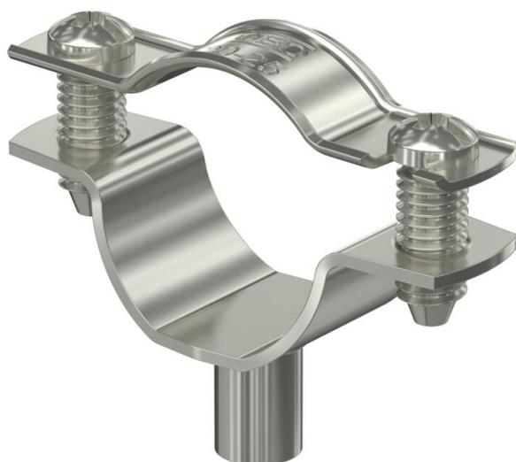
Abstandschele zur Montage von Rohren und Kabeln an Wand, Decke und Boden. Mit selbstsicherndem Oberteil. Befestigung über Ansatz mit Innengewinde. Oberflächen G und FT ab Schellengröße 20 geeignet für Montage mit Nagelgerät oder Bolzensetzgerät. Zugelassen für den Funktionserhalt nach DIN 4102 Teil 12, Funktionserhaltklassen E 30 bis E 90.
