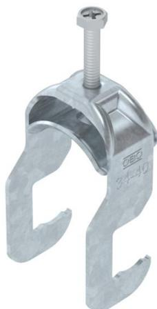
Bügelschelle mit RS-Fuß, Metalldruckwanne mit gerundeten Kanten für Kabelschutz. Zur vertikalen und horizontalen Montage von 1 Einzelkabel an Rundprofilen oder Rohren. Mit 1-gängiger Schraube an Druckwanne, universeller Sechskant-Schraubenkopf SW10, mit Schlitz und Kreuzschlitz. Passend zu allen Rundprofileisen bzw. Rohren mit Durchmesser bis 22 mm. Geeignet für Montage im Innen- und Außenbereich. Der Einsatz einer Gegenwanne wird empfohlen.
