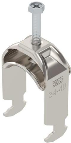
Bügelshelle mit Hammerkopf-Fuß, Metalldruckwanne mit gerundeten Kanten für Kabelschutz. Zur vertikalen und horizontalen Montage von 1 Einzelkabel an C-Profileschiene. Für Schlitzweite 16 - 17 mm. Mit 1-gängiger Schraube an Druckwanne, universeller Sechskant-Schraubenkopf SW10, mit Schlitz und Kreuzschlitz. Geeignet für Montage im Innen- und Außenbereich. Der Einsatz einer Gegenwanne wird empfohlen.
