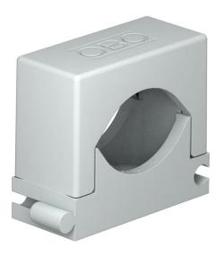
Universalschelle für Einzelbefestigung von Kabeln, Leitungen und Rohren, alle Größen sind beliebig untereinander anreihbar, mit Klebefuß, Langloch und zum Aufschrauben auf Gewinde M6.
