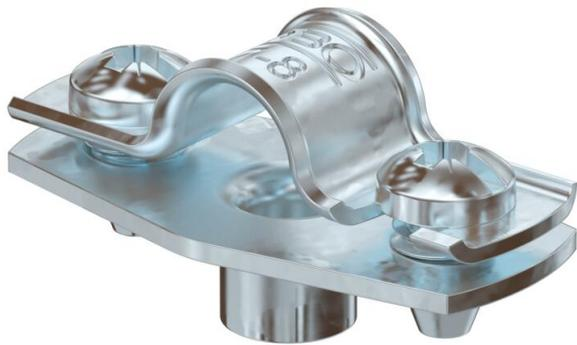
Abstandschelle zur Montage von Rohren und Kabeln an Wand, Decke und Boden. Mit selbstsicherndem Oberteil. Befestigung über Ansatz mit Innengewinde. Oberflächen G und FT ab Schellengröße 20 geeignet für Montage mit Nagelgerät oder Bolzensetzgerät. Zugelassen für den Funktionserhalt nach DIN 4102 Teil 12, Funktionserhaltklassen E 30 bis E 90.
