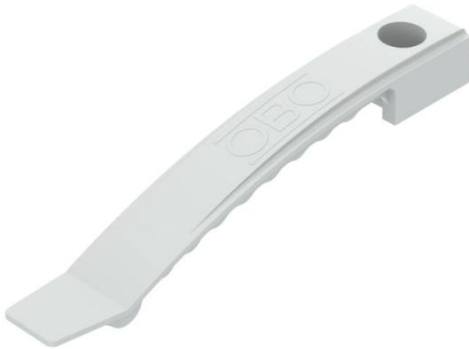
Kabelklammer zum Montieren von bis zu 8 Leitungen NYM 3 x 1,5 mm<sup>2</sup> z. B. an Zwischenwänden oder -decken. Geeignet zum Befestigen mit gas- und akkubetriebenen Setzgeräten der Marken Bosch, Fischer und Spit (Nasendurchmesser außen Ø 11 mm). Klemmhöhe 9 mm, mit Distanzstück 13 mm. Befestigungsloch Ø 11 mm.
