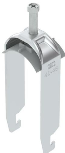
Bügelshelle mit U-Fuß, Kunststoffdruckwanne aus Polypropylen. Zur vertikalen und horizontalen Montage von 2 Einzelkabeln an C-Profilshiene. Für Schlitzweite 18 - 22 mm. Mit 1-gängiger Schraube an Druckwanne, universeller Sechskant-Schraubenkopf SW10, mit Schlitz und Kreuzschlitz. Geeignet für Montage im Innen- und Außenbereich. Mehrere Kabel sollten durch Doppelwannen getrennt werden. Der Einsatz einer Gegenwanne wird empfohlen.
