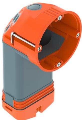
Hohlwand-Elektronikdose mit Membraneinführungen und zusätzlichem Verdrahtungsraum, für den Einsatz in Hohlwänden mit einer Einbautiefe von mindestens 75 mm und einer Plattenstärke von 5 - 35 mm.
