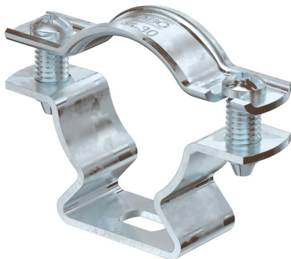
Abstandschele zur Montage von Röhren und Kabeln an Wand, Decke und Boden. Mit selbstsicherndem Oberteil. Befestigung über Langloch. Zugelassen für den Funktionserhalt nach DIN 4102 Teil 12, Funktionserhaltklassen E 30 bis E 90.
