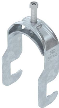
Bügelschelle mit RS-Fuß, Metalldruckwanne mit gerundeten Kanten für Kabelschutz. Zur vertikalen und horizontalen Montage von 1 Einzelkabel an Rundprofilen oder Rohren. Mit 1-gängiger Schraube an Druckwanne, universeller Sechskant-Schraubenkopf SW10, mit Schlitz und Kreuzschlitz. Passend zu allen Rundprofileisen bzw. Rohren mit Durchmesser bis 22 mm. Geeignet für Montage im Innen- und Außenbereich. Der Einsatz einer Gegenwanne wird empfohlen.
