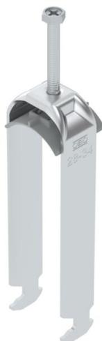
Bügelshelle mit Hammerkopf-Fuß, Kunststoffdruckwanne aus Polypropylen. Zur vertikalen und horizontalen Montage von 3 Einzelkabeln an C-Profilshiene. Für Schlitzweite 16 - 17 mm. Mit 1-gängiger Schraube an Druckwanne, universeller Sechskant-Schraubenkopf SW10, mit Schlitz und Kreuzschlitz. Geeignet für Montage im Innen- und Außenbereich. Mehrere Kabel sollten durch Doppelwannen getrennt werden. Der Einsatz einer Gegenwanne wird empfohlen.
