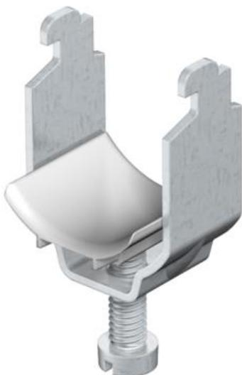
Passend zu allen Profilschienen mit 11 - 12 mm Schlitzweite, mindestens 6,5 mm lichter Innenhöhe und mindestens 18,5 mm lichter Innenbreite; Schelle und Schraube aus Aluminium ALMg3, Druckwanne aus Polypropylen, halogenfrei, lichtgrau RAL 7035.
