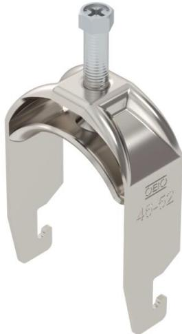
Bügelschelle mit U-Fuß, Metalldruckwanne mit gerundeten Kanten für Kabelschutz. Zur vertikalen und horizontalen Montage von 1 Einzelkabel an C-Profil-schiene. Für Schlitzweite 18 - 22 mm. Mit 1-gängiger Schraube an Druckwanne, universeller Sechskant-Schraubenkopf SW10, mit Schlitz und Kreuzschlitz. Geeignet für Montage im Innen- und Außenbereich. Der Einsatz einer Gegenwanne wird empfohlen.
