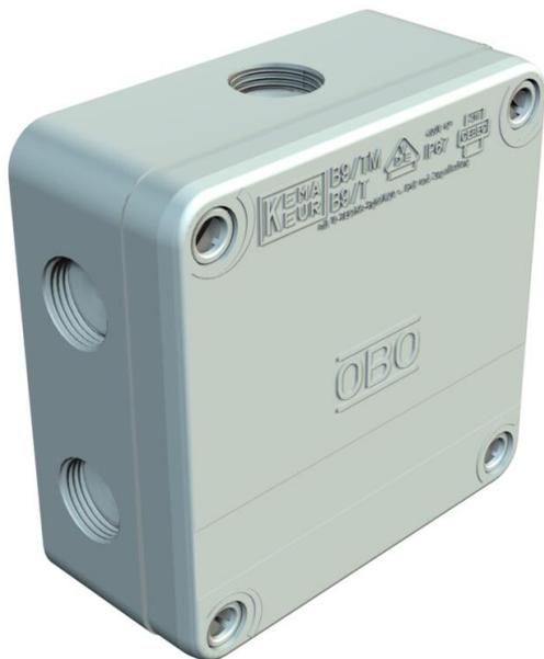
Der Kabelabzweigkasten B9/T... besteht aus zwei verschiedenen halogenfreien Kunststoffkomponenten. Er hat 8 Gewindeeinführungen mit Durchstoßmembranen (7 x PG16 seitlich und 1 x PG16 im Boden) sowie eine Membraneinführung im Boden für Kabeldurchmesser bis 15 mm. Bei Verwendung der Kabelverschraubungen (zusätzliche Zugentlastung) ist ein Entfernen der Membran nicht erforderlich (Zeitgewinn). Schutzart IP 67 bei Durchstoßmembrane und bei Kabelverschraubung ohne Entfernen der Durchstoßmembrane.
