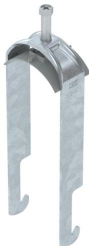
Bügel­schelle mit W-Fuß, Kunststoffdruckwanne aus Polypropylen. Zur vertikalen und horizontalen Montage von 2 Einzelkabeln an Winkeleisen bis < 40 mm. Mit 1-gängiger Schraube an Druckwanne, universeller Sechskant-Schraubenkopf SW10, mit Schlitz und Kreuzschlitz. Geeignet für Montage im Innen- und Außenbereich. Mehrere Kabel sollten durch Doppelwannen getrennt werden. Der Einsatz einer Gegenwanne wird empfohlen.
