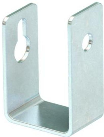
Trennwinkel als Installationshilfe bei Wandmontage des Brandschutzkanals PY-ROLINE® Con D BSK, Typ BSK 090521 und Typ BSK 120521. Montage des Winkels direkt an den Befestigungsdübeln des Brandschutzkanals.
