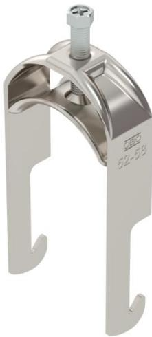
Bügelschelle mit W-Fuß, Metalldruckwanne mit gerundeten Kanten für Kabelschutz. Zur vertikalen und horizontalen Montage von 1 Einzelkabel an Winkeleisen bis < 40 mm. Mit 1-gängiger Schraube an Druckwanne, universeller Sechs-kant-Schraubenkopf SW10, mit Schlitz und Kreuzschlitz. Geeignet für Montage im Innen- und Außenbereich. Der Einsatz einer Gegenwanne wird empfohlen.
